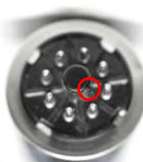
Pin prowadzący na dnie lampy.
